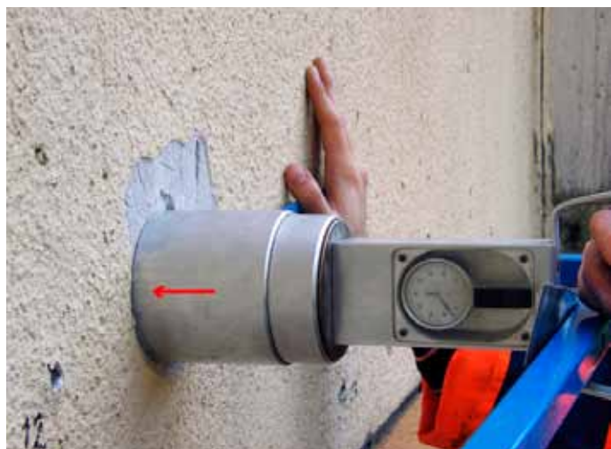
Obr. 5: Nedeštruktívna skúška pevnosti v tlaku tzv. Hanečkovou metódou
