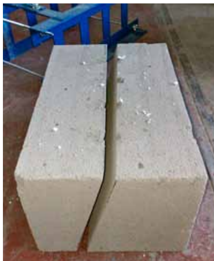
Obr. 10: Vzorka s trhlinou sklonenou o 15°
