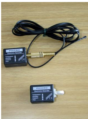
Registrácia povrchovej teploty a registrácia teploty a relatívnej vlhkosti vnútorného vzduchu
