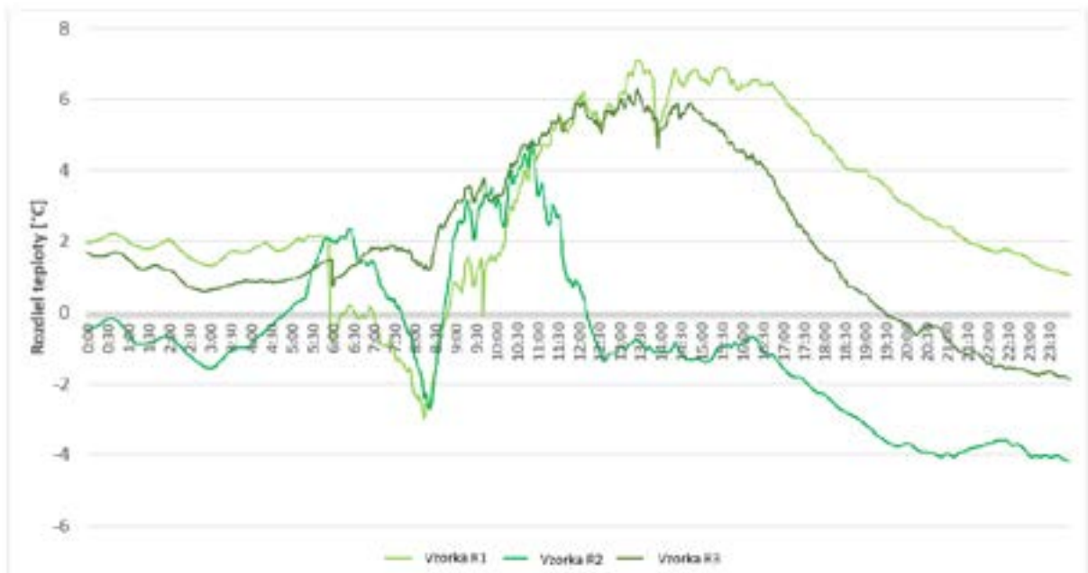
Obr. 6 - Porovnanie povrchovej teploty medzi nezavlažovanými a zavlažovanými vzorkami. Porovnané dni: 05.06.2022 a 23.06.2022
