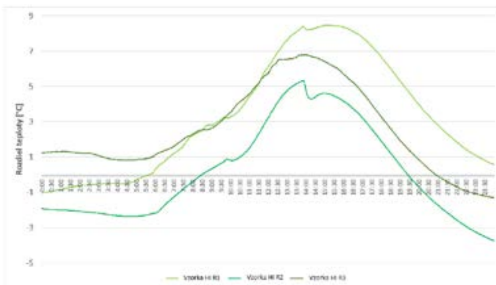
Obr. 7 - Porovnanie povrchovej teploty medzi nezavlažovanými a zavlažovanými vzorkami. Porovnané dni: 05.06.2022 a 23.06.2022
