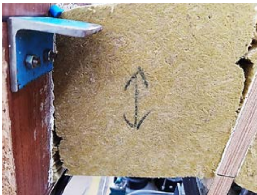
Obr. 1 - Zkouška pevnosti ve smyku - porušení ohybovým momentem vzorku o příliš velké tloušťce
