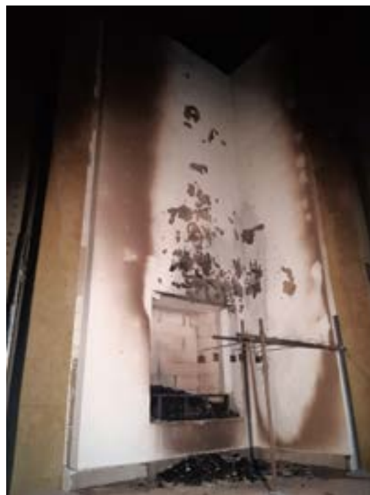
Obr. 4 - Zkušební vzorek ETICS po zkoušce
