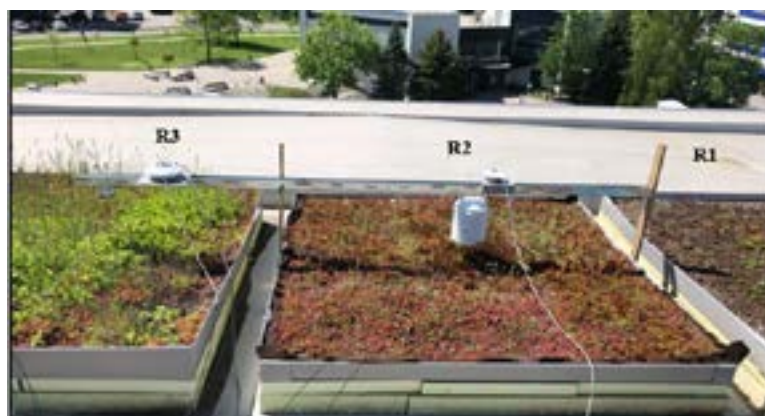
Obr. 8 - Znárodnenie zazelenania a farebnosti povrchu skúmaných vzoriek. Skladby vľavo – R3, v strede – R2, vpravo – R1
