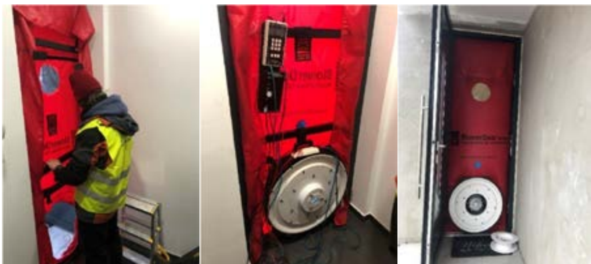
Obr. 3 - Osadenie ventilátora do vstupných dverí rodinného domu
