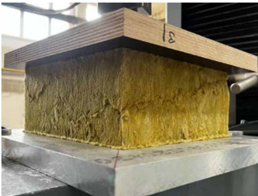
Obr. 7 - Porušení lamely z MW vzpěrným účinkem vláken při zkoušce pevnosti v tlaku
