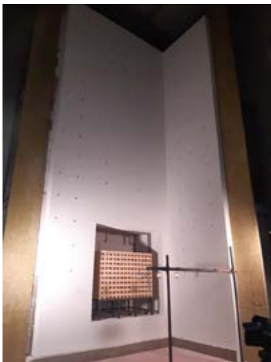
Obr. 3 - Zkušební vzorek ETICS před zkouškou
